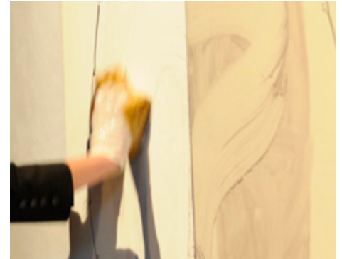
Nach einer Einwirkzeit von ca. 15 Minuten kann das Graffiti rückstandslos „abgewaschen“ werden. Die Oberfläche der Tafel wird dabei nicht beschädigt.
